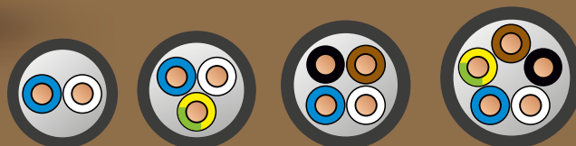
Схема расцветки изолированных жил
