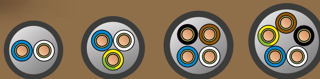
Схема расцветки изолированных жил
