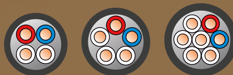
Схема расцветки изолированных жил
