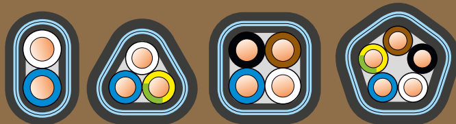
Схема расцветки изолированных жил
