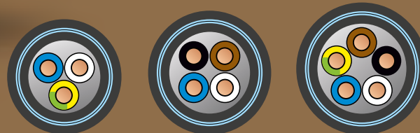
Схема расцветки изолированных жил
