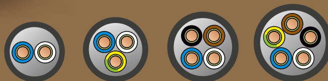
Схема расцветки изолированных жил
